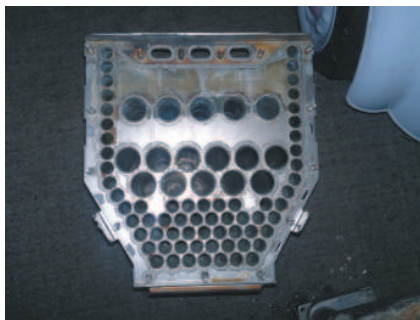
Fot. 5. Wysokosprawna komora spalania o przepływie laminarnym: większym w wyższych warstwach, blisko palnika, a mniejszym w dolnej części wymiennika
