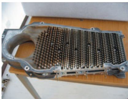
Fot. 8. Nietypowy odlew wymiennika zwiększający powierzchnię grzewczą i sprawność kondensacji
