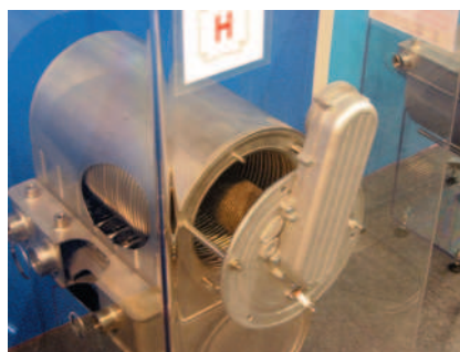
Fot. 2. Komora spalania z przepływem ustalonym laminarnym (warstwowym)
